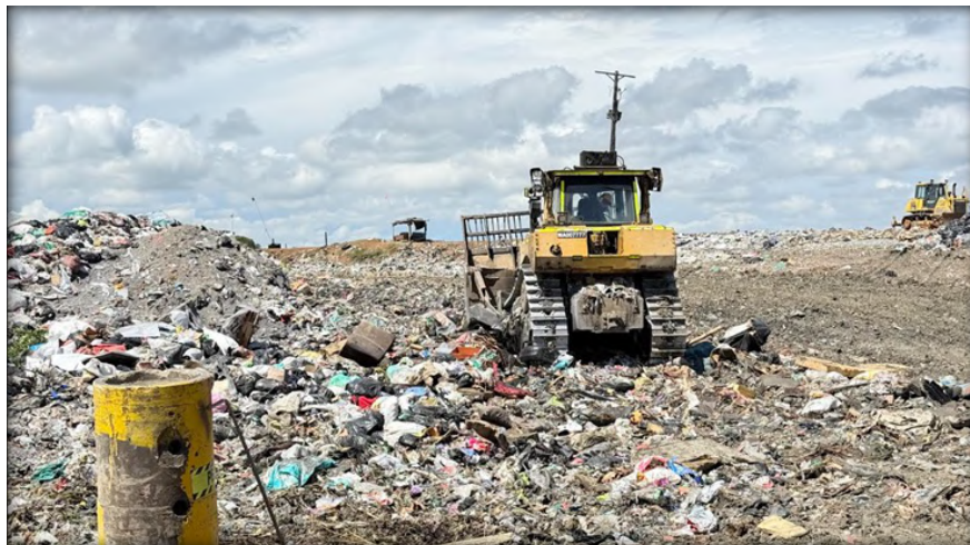
Figura 37. Proceso de disposición y compactación de residuos sólidos en el Relleno Sanitario La Glorita
